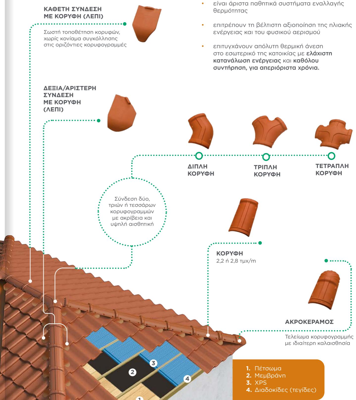
Οι αεριζόμενες θερμοσυσσωρευτικές κεραμοσκεπές από πλό που κατασκευάζονται με τα **κεραμίδια** της **KEBE** και την πλήρη σειρά ειδικών τεμαχίων στέγης:
